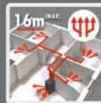
16 metri di canalizzazione utilizzando 1 uscita - 8 metri di canalizzazione utilizzando 2 uscite
