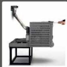
Dettaglio sistema di estrazione per caricamento pellet
