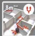
8 metri di canalizzazione utilizzando 1 uscita - 4 metri di canalizzazione utilizzando 2 uscite
